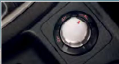
Датчик включения полного привода (4WD).
