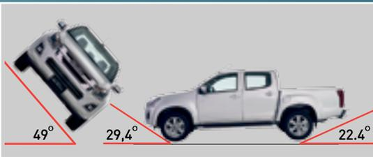
Параметры полного привода off-road (вместе с задним бампером и колесами 255/60R18).
